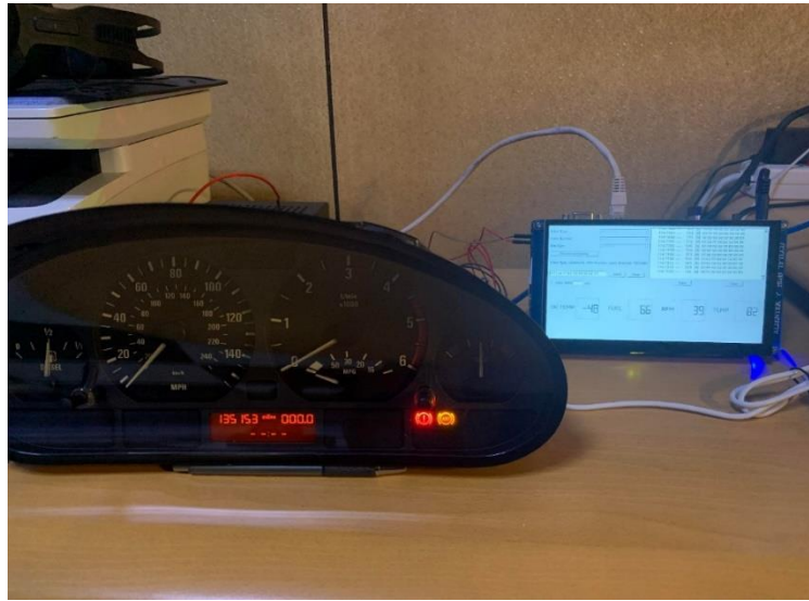
圖十：CAN 資安實驗平臺之實現
