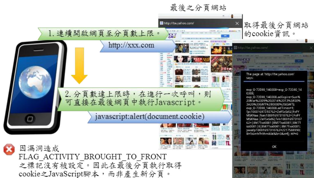
圖七、CVE-2011-2357 Android 沙箱漏洞與瀏覽器 XSS 注入攻擊示意圖
