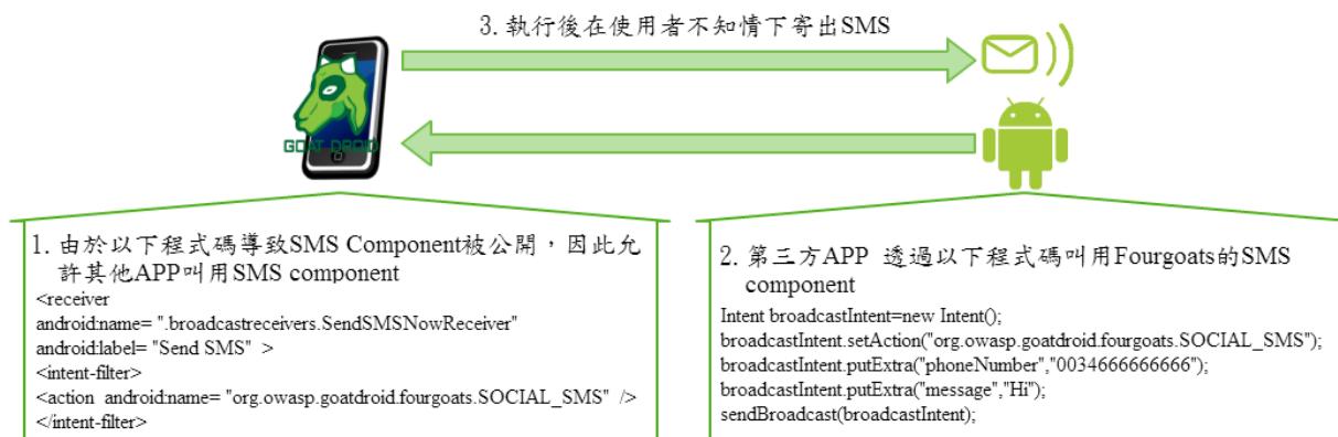
圖八、FourGoats - Intent Spoofing 案例之漏洞與利用示意圖
